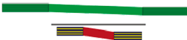
Afbeelding 2: Eenzelfde uitlijningsfout heeft een veel grotere impact als de spanlengte korter is.
