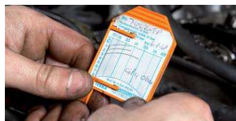
4 Houdt de cilinder de druk vast? Of lekt hij weg langs de zuigerveren of kleppen?
