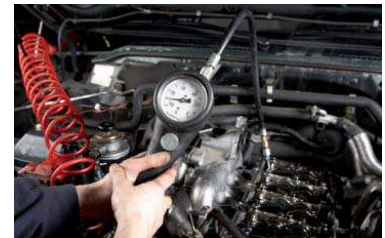
3 In dit geval geen twijfel: nul compressie in cilinder 4. Maar wat als de druk in alle vier gelijk is? Alleen een geijkte compressiemeter vertelt of die druk hoog genoeg is.
