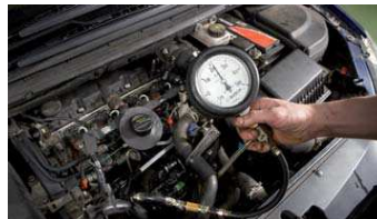
2 Is er voldoende brandstofdruk? Zo nee, dan is misschien het brandstoffilter of de aanvoerpomp niet goed.
