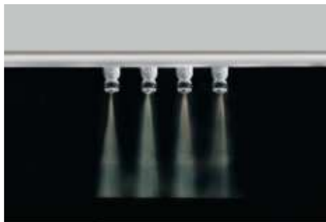
Correct werkende injectoren
