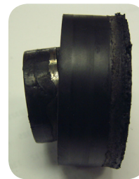
Rol oververhit geraakt door onjuiste riem uitlijning en / of te strak gespannen riemspanner.
